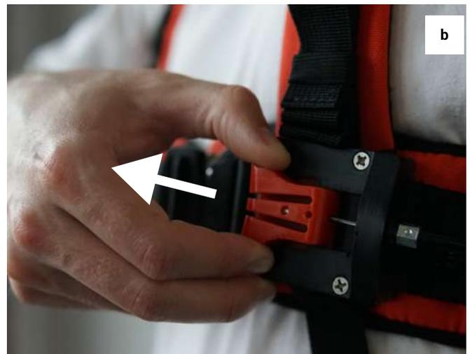
Figure 4: Désenclencher le mécanisme de l'exosquelette en positionnant le bouton ON/OFF sur OFF.
