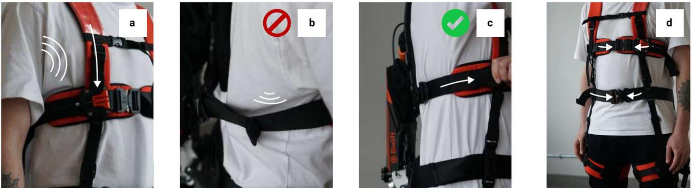
Figure 14: Friction des bretelles sous les aisselles.
