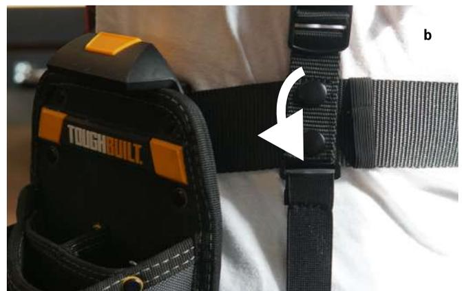
Figure 5: Pose de la poche à outils personnelle sur l'exosquelette Biolift.
