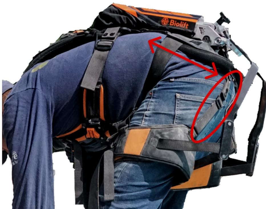
**⚠ Réglages :** L'exosquelette doit être réglé correctement et spécifiquement pour chaque utilisateur en suivant les instructions de ce manuel d'utilisation. Un ajustement trop serré ou trop lâche peut entraîner des dysfonctionnements ou des blessures.
